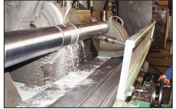
Sayfa 160 Resim 4: Kromajı tamamlanmış malzeme üzerinde kalıntı kirlilikler, zımpara ile siliniyor, parlatılıyor
