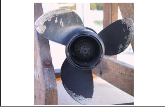
Sayfa 138 Resim 1: Deniz Taşıtlarının pervanelerinin paslanmasını, bozulmasını önlemek için berilyumlu alaşımlardan yararlanır.
