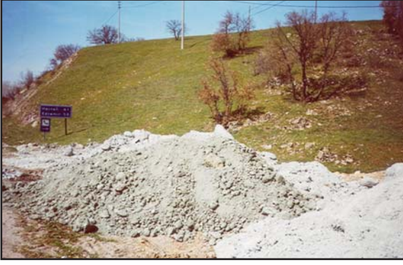
Sayfa 51 Resim 12: Yollara serilmek için hazırlanmış içinde asbest bulunan kurşuni - gri renkte toprak yığını.
