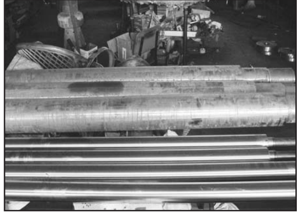
Resim 2: Paslı demir borularının kromajdan önce ve sonraki hali.
