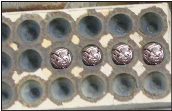
Sayfa 167 Resim 3a - 3b: Altın ayarlanması için kullanılan fırın ve çimento kupilasyonu içindeki kurşun küreleri.
