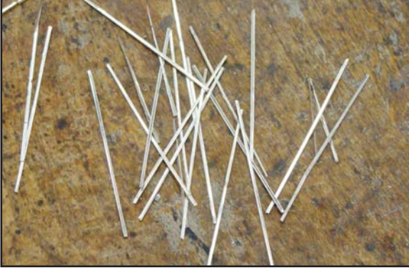
Sayfa 157 Resim 1: Elektrik kaynağında kullanılan Elektrod ( çubuklar)
