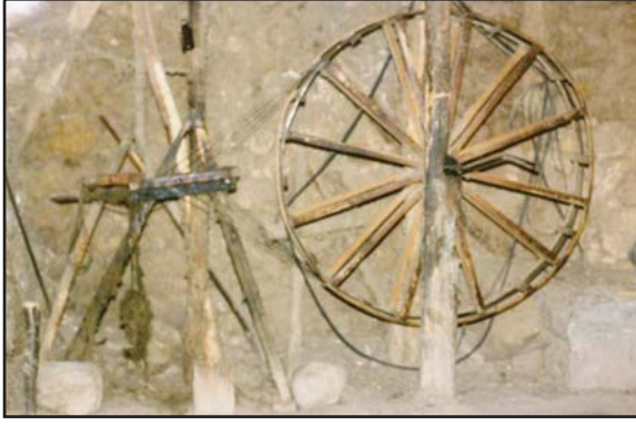
Sayfa 192 Resim 13: Evlerde kenevirden ip ve urgan yapımında kullanılan çıkırık.
