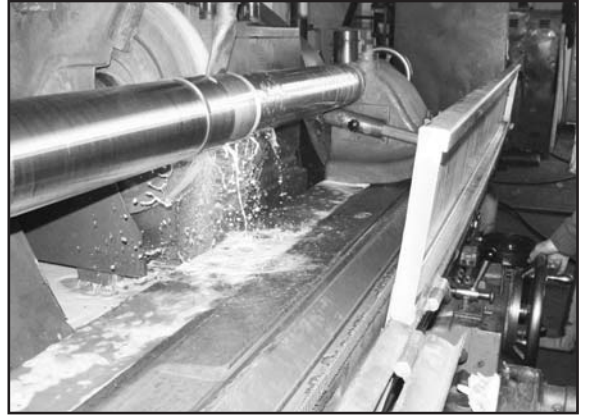
Resim 4: Kromajı tamamlanmış malzeme üzerinde kalıntı kirlilikler, zımpara ile siliniyor, parlatılıyor
