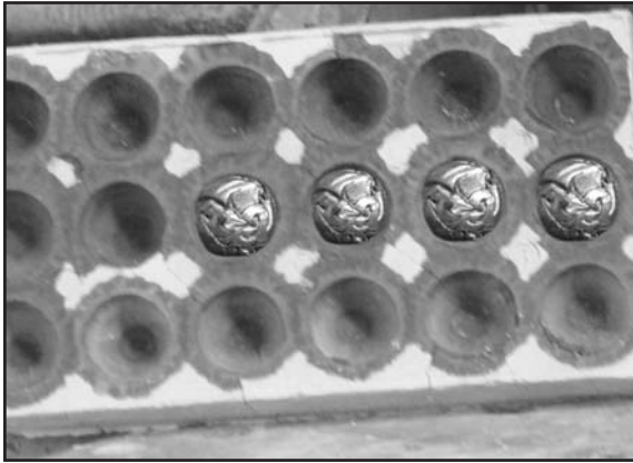
Resim 3a - 3b: Altın ayarlanması için kullanılan fırın ve çimento kupilasyonu içindeki kurşun küreleri.
