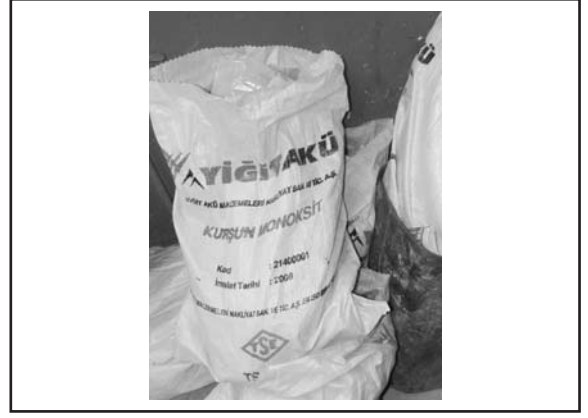
Resim 2: Akü yapımında kullanılan kurşun oksit tozu
