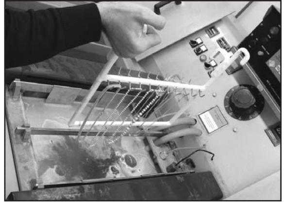
Resim 2: Kuyumculukta Elektroliz ile kaplama
