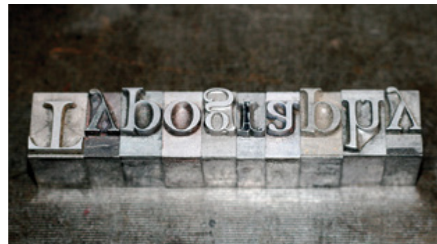
Resim 2. Matbaada baskı için ayna görüntüsü şeklinde kesilmiş fontlar
