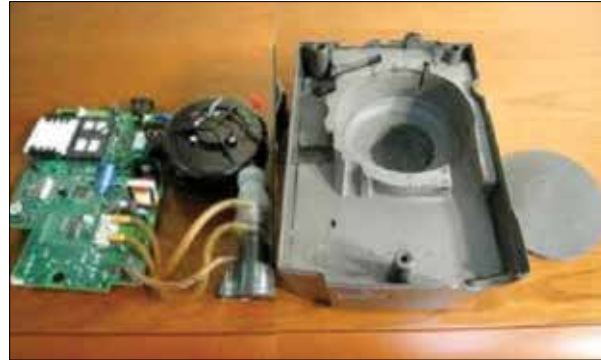
Şekil 1. CPAP cihazının pozitif basınç veren motor ünitesi
